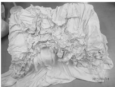
図2 熱で収縮した遮光カーテン
